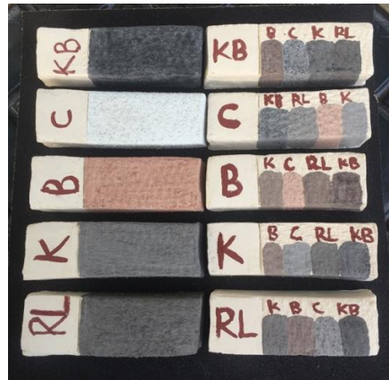
Rajah 1.6 : Sampel ujikaji licau iaitu batu Sungai Moyog, kayu bakau, rumpai laut, keladi dan cengkerang yang telah di aplikasi pada permukaan jasad spesimen sebelum dibakar
